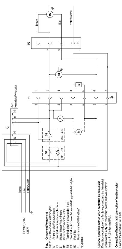
Connect the runtime-meter to P1:4 and P1:5. Alternativt driftsätt vid hygrostatstyrning
